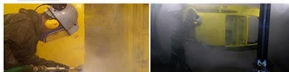
**Sverniciatura all'acqua**, oppure con bagno chimico di decapaggio.
