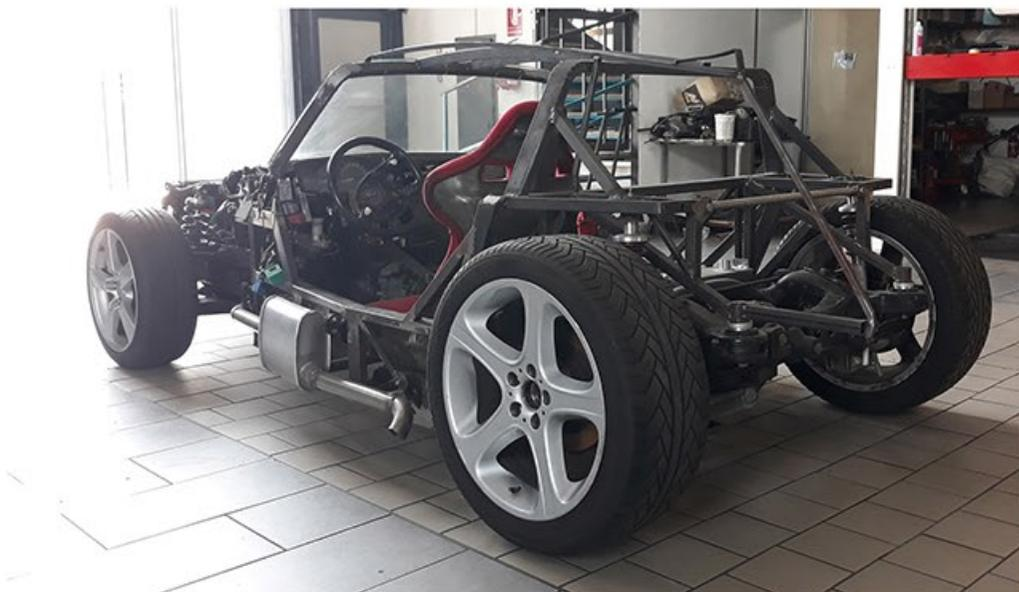
*La tecnologia del reverse engineering in questo caso è stata messa a profitto per adattare una carrozzeria esclusiva al telaio di cui abbiamo fatto la scansione. Questo progetto è attualmente in fase di sviluppo presso il nostro Laboratorio.*
