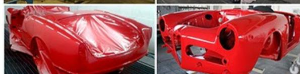
**Verniciatura con Applicazione smalto**, lucidatura, effetto verniciatura alla nitro dell'epoca
